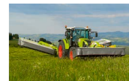
Det kompakte ophæng på frontliften giver skårlæggeren en stor frihøjde over jorden i forageren.
