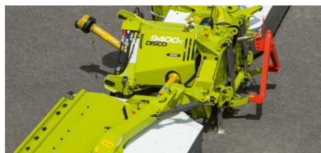
Beskyttelse med hydraulisk non-stop-påkørselssikring i tilfælde af kollision: Skårlæggerenheden svinger ud og går automatisk tilbage til udgangsstillingen.
