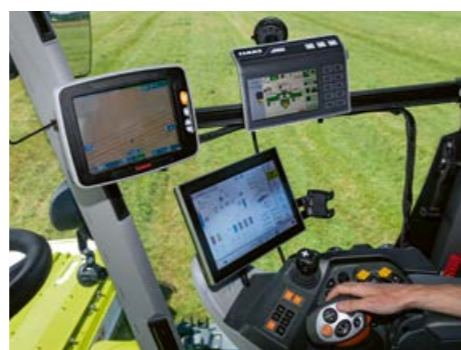
Komfortabel betjening, fx med diverse ISOBUS terminaler og ISOBUS funktionstasterne på joysticket.
