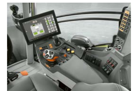
Hvis traktoren er udstyret med en ISOBUS-kompatibel terminal, kan forhåndsindstillingsbetingelser til CONTOUR ske direkte via denne.
