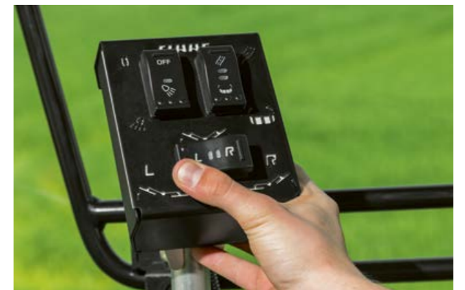
Til DISCO 1100 TREND fås en praktisk betjeningsenhed til enkelthævning, indklapning i transportstilling og tænd og sluk af arbejdslygter (ekstraudstyr).
