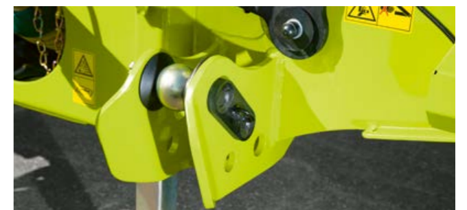
Styrelasker til liftarmene for bekvem montering.
