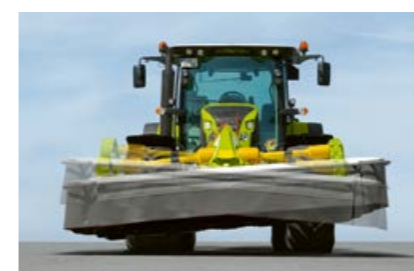
Tilpasning på tværs af kørselsretningen med frit pendlende ophæng.
